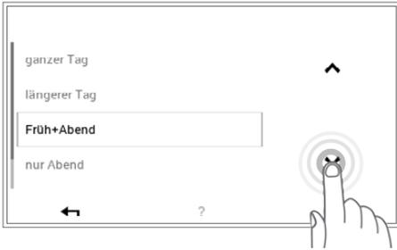
6 Mit den **vertikalen Pfeilen** (^v) das neue Tagesprogramm auswählen und mit **OK** bestätigen.
