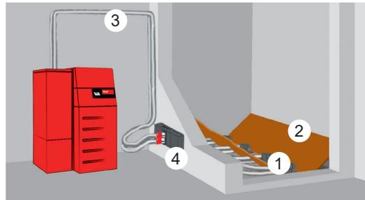
Saugsystem mit Absaugsonden
